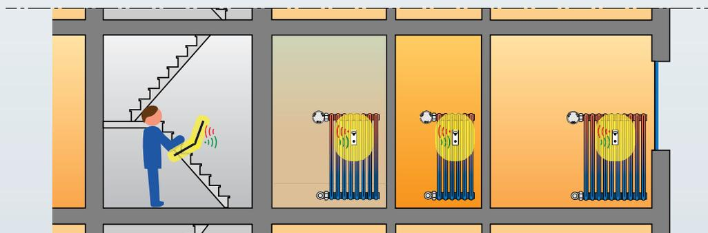
*Impianti con ripartitori di calore a trasmissione dati bidirezionale all'interno dell'edificio*
